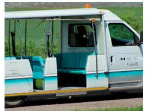
Navette accessible : banc et rampe amovibles
